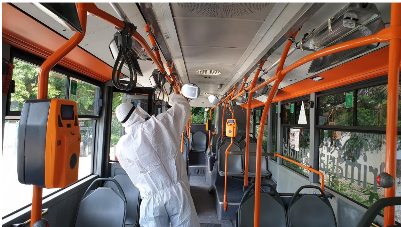
Fig. Sistem integrat bazat pe module cu lămpi UV-C, aplicat la un autobuz STB
