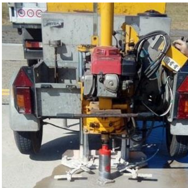
Fig: Sistem carotieră, pentru determinarea rezistenței unei piste aeroportuare
